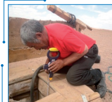
Хүдгийн усны түвшинг гар хийцийн түвшин хэмжигчээр хэмжиж буй байдал
